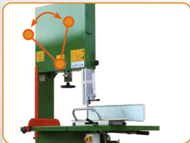
REGOLAZIONE DELL'INCLINAZIONE VOLANO SIA SUPERIORE CHE INFERIORE
