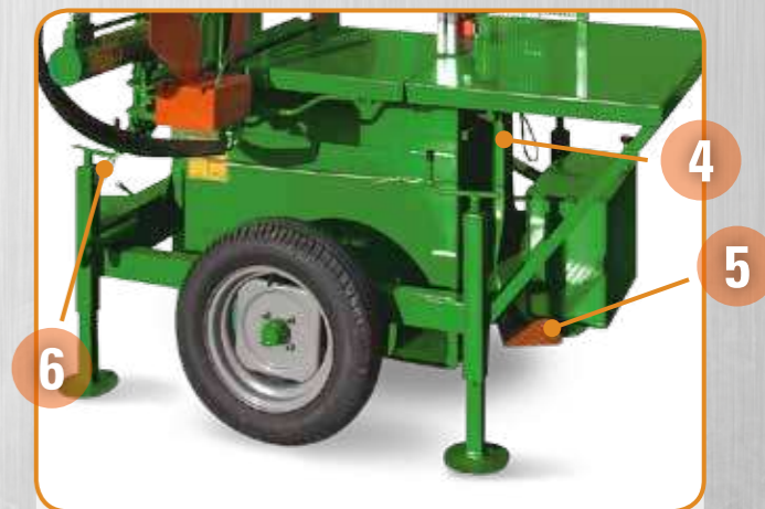
4. BOCCHETTA ESTRAZIONE SEGATURA 5. PEDALE FRENO D'EMERGENZA BREVETTATO 6. SISTEMA DI DISINSERIMENTO CINGHIE DI TRAZIONE
